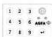
Figura 8: Teclado opcional para substituir a tecla para ligar e desligar a unidade.
